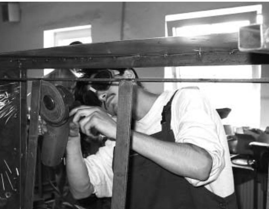
Sefergjan, ein hagerer, junger Mann mit dunklen Haaren, ist dabei, mit einem Winkelschleifer Schweißnähte an verschiedenen Stellen eines quaderförmigen Werkstückes abzuschleifen. Mit Blaumann und Schutzbrille bekleidet, schaut er durch den ca. 50 x 120 cm großen, in beide Richtungen offenen Kasten aus blankem Metall hindurch und lässt die Funken sprühen.
